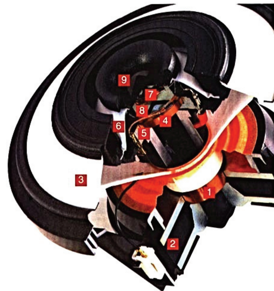
Vue en coupe du fantastique haut-parleur triaxial SCS Source à Cohérence Spatiale. 1 - Bobine mobile de la section bas-médium (230 à 1 200 Hz) entraînant le diaphragme annulaire (3) et baignant dans le flux produit par l'aimant (2). 4 - Bobine mobile de la section haut-médium (1 200 à 4 300 Hz) jouant dans le flux produit par l'aimant (5) et entraînant le diaphragme annulaire (6) à structure alvéolaire identique à celle du bas-médium. 8 - Bobine mobile du tweeter (qui prend le relais au-delà de 4 300 Hz) entraînant le dôme (9) et jouant dans l'entrefer d'un circuit magnétique avec aimant Néodyme.
